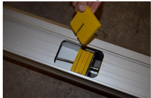
Überflüssige Gewichte können mit einem Stabmagnet (optional) aus dem Gewichtskorb entfernt werden.
