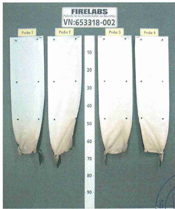
Bild 4 Aussehen des Probekörpers nach dem Brandversuch
