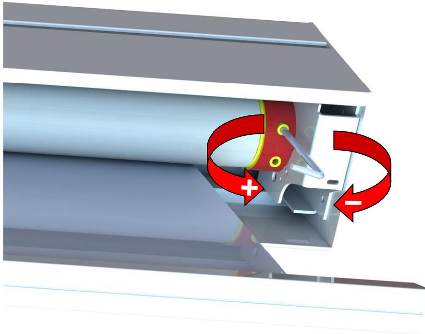
Zum Einstellen der Endlage muss der Deckel demontiert werden.
