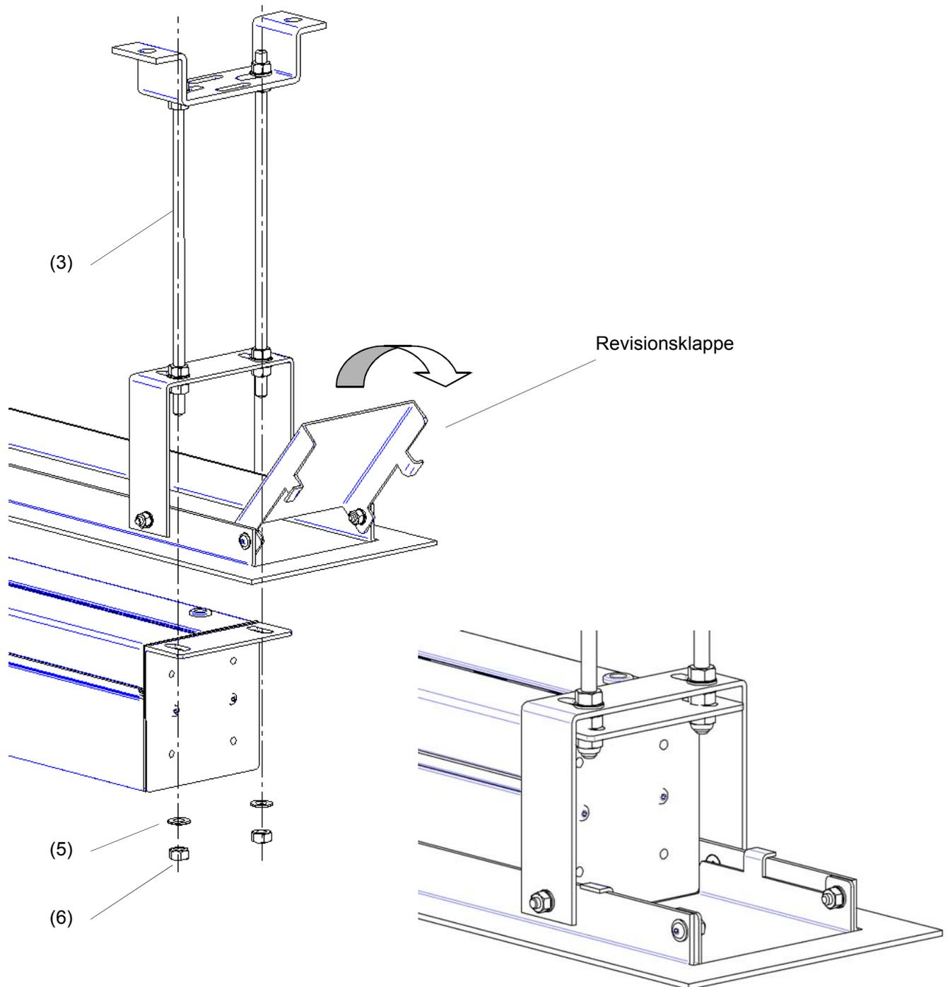
Öffnen Sie von unten die Revisionsklappen, schieben Sie die Lichtbildwand über die Gewindestangen (3), und sichern Sie die Lichtbildwand mit den Unterlegscheiben (5) und Sicherungsmuttern (6).
