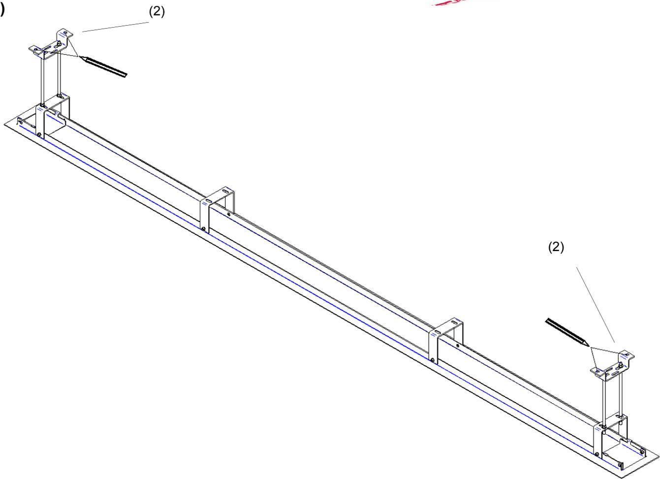
Übertragen Sie das Bohrbild der Deckenhalterung (2) auf die Decke.
